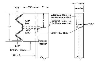
STEEL GUARDRAIL POST (WOOD BLOCK)
